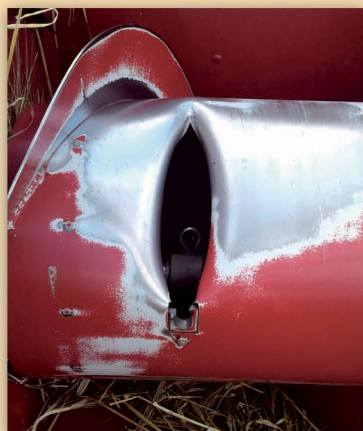
Рис. 5. Выход из строя пальцевого механизма шнека жатки (разрыв шнека)
