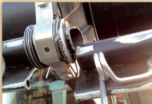
Рис. 2. Излом граблины мотовила жатки
