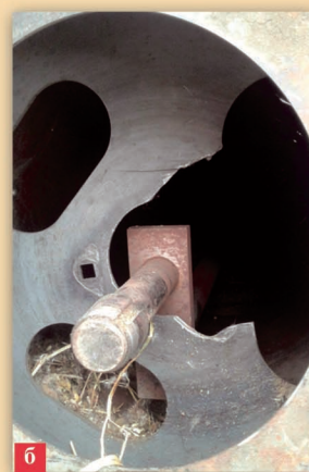
Рис. 1. Неисправности бitera: а — выход из строя подшипников вала; б — излом проставки
