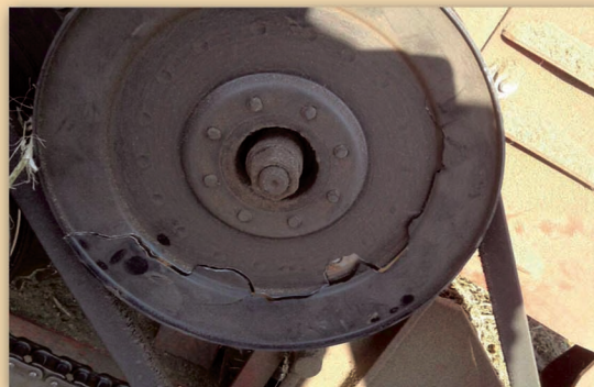
Рис. 3. Изломы шкивов привода режущего аппарата
