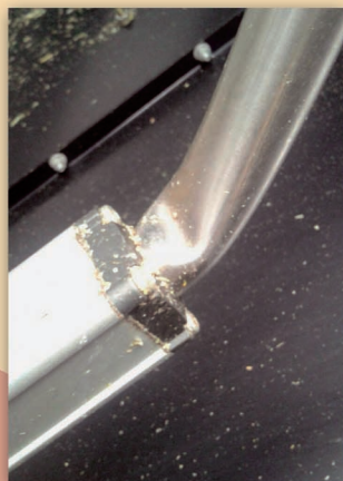
Рис. 5. Выход из строя пальцевого механизма шнека жатки (разрыв шнека)
