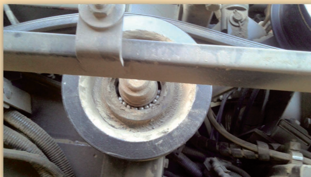
Рис. 6. Выход из строя подшипников шкива леникса
